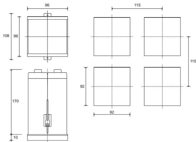
Dimensioni di ingombro: 96x96mm (1/4 DIN), profondità 167mm
